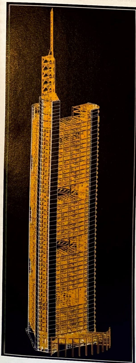
Bild 1. Commerzbank Tower Frankfurt/M.: Die Software bocad hatte eine durchgängige Bearbeitung des Tragwerks aus Stahlbeton und einer Fassade aus Glas und Aluminium ermöglicht. (Abb.: bocad)
